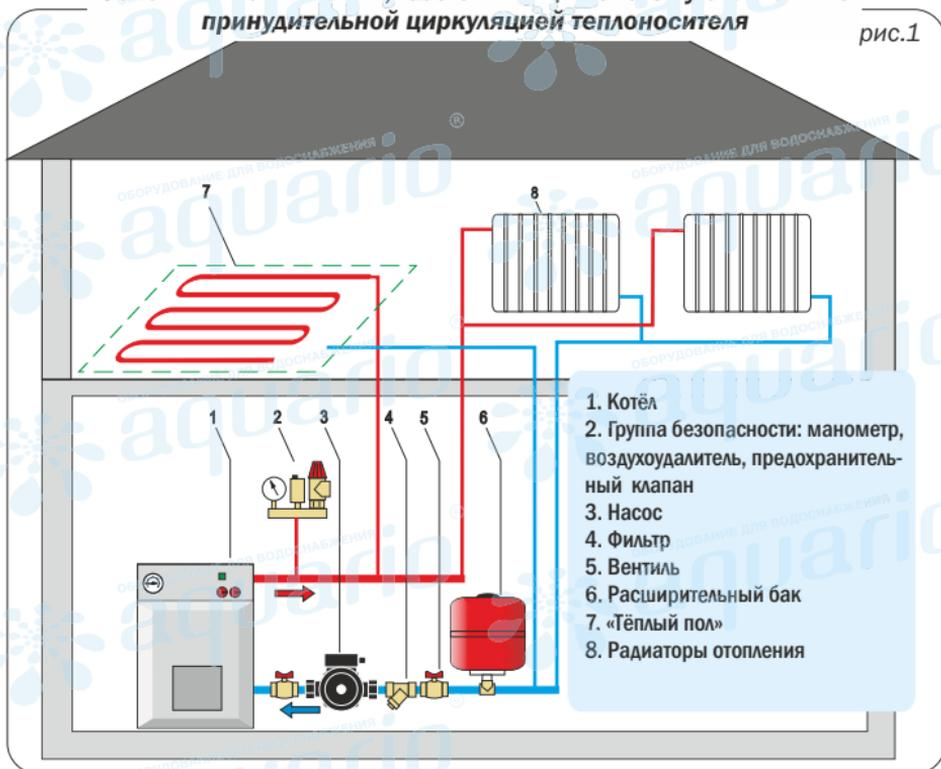
Тип насоса - центробежный. Двигатель асинхронный с «мокрым ротором», т.е. ротор двигателя, вал и подшипники скольжения во время работы охлаждаются и смазываются перекачиваемой жидкостью. Такая конструкция обеспечивает абсолютно бесшумную работу насоса.
