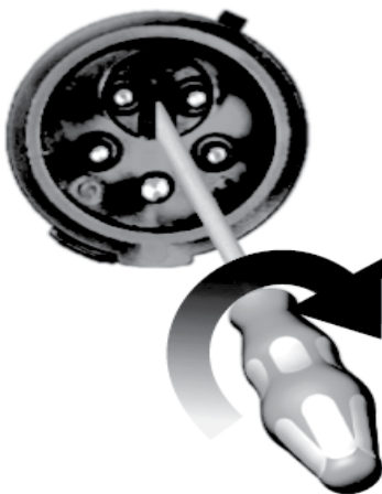
Նկար 17 Ֆազային ինվերտերով եռաֆազ կառավարման պահարանի ֆազերի փոփոխում
