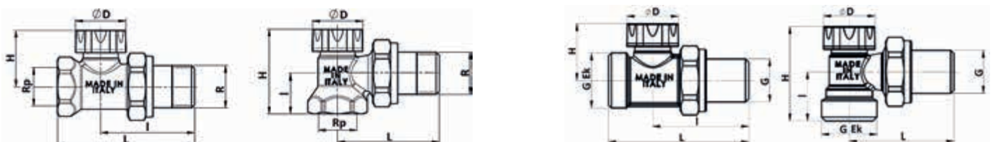
Рис. 31. Устройство запорно-балансировочного клапана типа SVL
