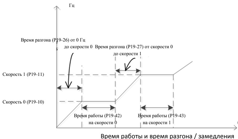
Внимание: Если время разгона/замедления и время работы на шаге X равны 0, то все следующие шаги игнорируются. Например, если P19-29 (время разгона/замедления на шаге 3) и P19-45 (время работы на шаге 3) равны 0, то шаги с 3 по 15 игнорируются.
