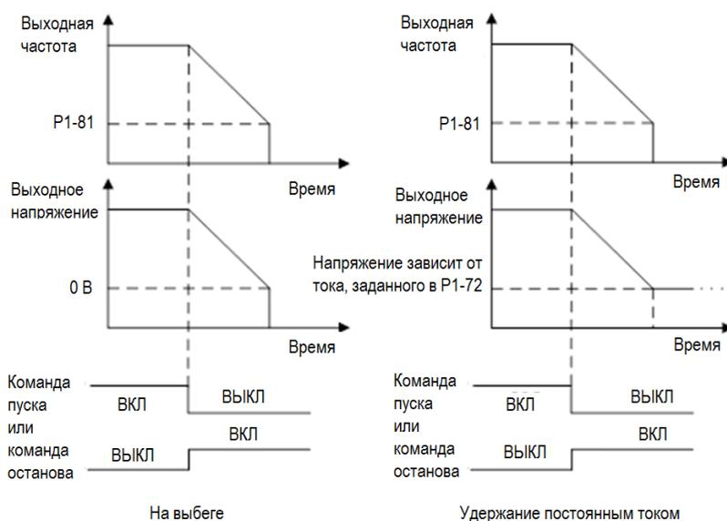
Примечание 1: если P1-81 > P1-84, работает функция P1-80, а функция торможения постоянным током работать не будет; если P1-81 < P1-84, функция торможения постоянным током будет работать, а функция P1-80 работать не будет.
