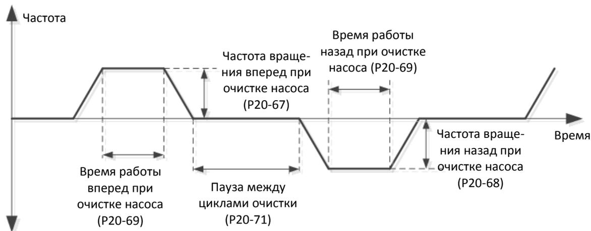
Для сигнала очистки насоса можно использовать любой дискретный вход, кроме FWD; этому входу необходимо назначить функцию 65: *Очистка насоса*. По окончании процедуры очистки ее можно повторить, отключив и вновь подав сигнал на этот вход. Функция очистки насоса не работает при P20-73 *Режим работы каскада насосов* = 1: *С постоянным ведущим* или при P20-40 *Работа в каскадном режиме по сети* = 1: *Включена*. Время разгона определяется параметром P0-60, время замедления – P0-61.
