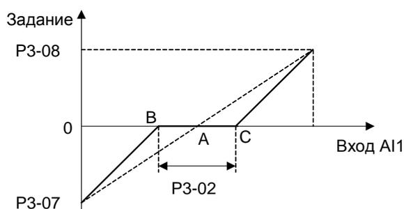
Точка А, показанная на рисунке, является аналоговым значением, которое соответствует заданному нулевому значению. Она рассчитывается с помощью аналоговых нижнего и верхнего опорных значений. После установки на AI1 зоны нулевого сигнала,  $U_{AB} = U_{AC} = P3-02 / 2$ . Если сигнал на входе AI1 находится между В и С, задание для входа AI1 равно 0.
