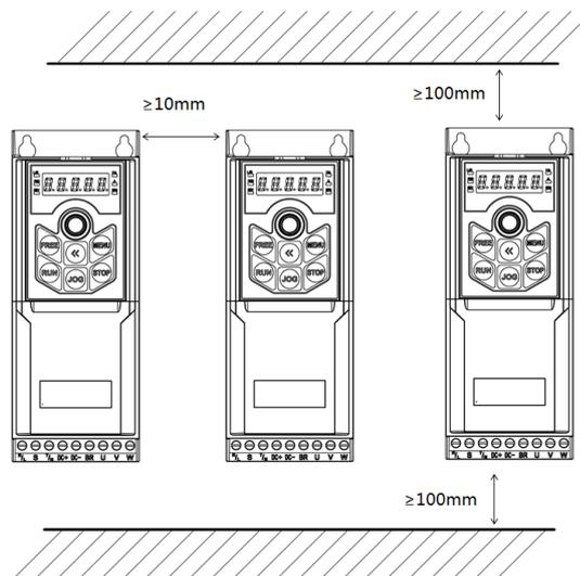
Если указанное расстояние между преобразователями обеспечить нельзя, то следует уменьшить ограничение температуры окружающего воздуха.
