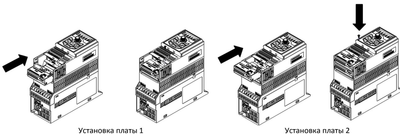
Вставьте плату по направляющим в нижней части модуля управления до упора. Закрепите плату расширения винтом в правом верхнем углу платы.
