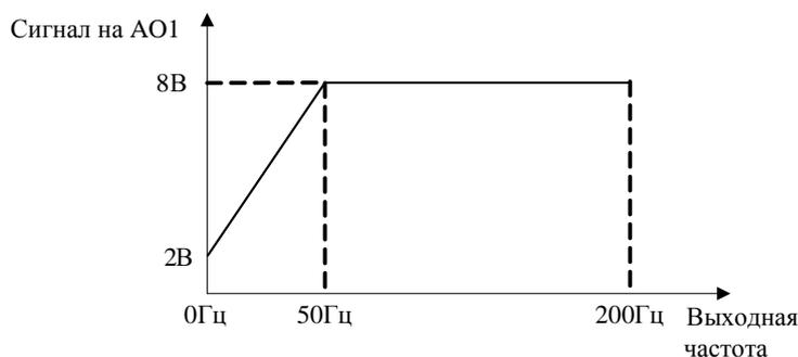
Если P3-52=80.00% (40 Гц), P3-53 = 10.00% (5 Гц), соотношение между выходной частотой и выходным сигналом на выходе АО1 показано ниже:
