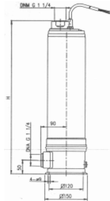
При стационарной установке насоса рекомендуем установить на напорной магистрали обратный клапан.
