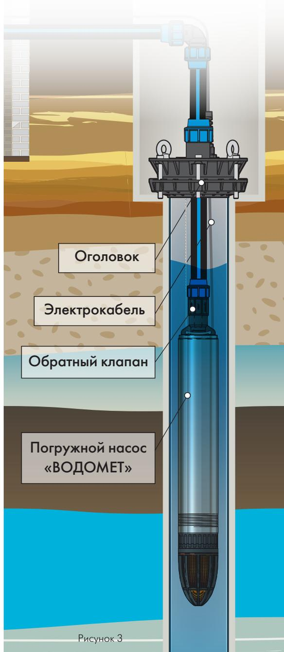
**ВНИМАНИЕ!** Насосы «ВОДОМЕТ» не оснащены встроенным обратным клапаном, поэтому, в некоторых случаях, монтаж обратного клапана рекомендуется производить на выходном штуцере насоса (обратный клапан идет в комплекте).
