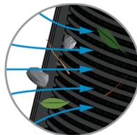
Максимальный диаметр пропускаемых частиц 2 мм
