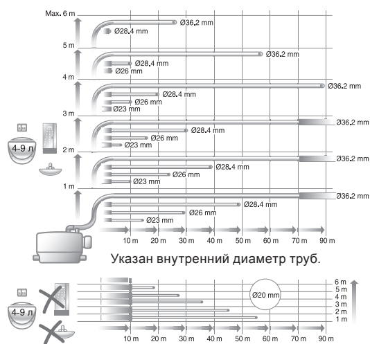
Рис. 61 Максимальная длина вертикальных и горизонтальных сливных труб
