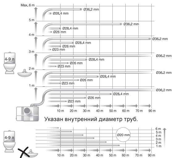
Рис. 55 Максимальная длина вертикальных и горизонтальных сливных труб
