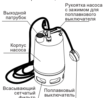
Рис. 1 Конструкция насосов Unilift AP
