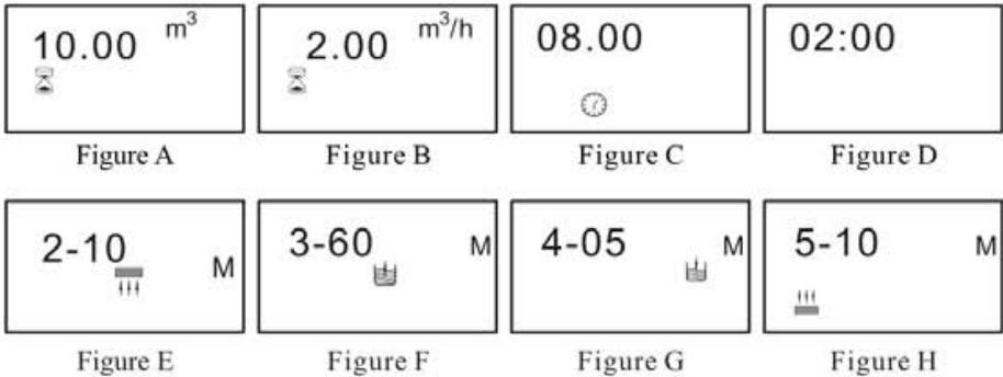
• В режиме фильтрация, экран будет выглядеть как на рисунках А / В / С / D; В режиме обратной промывки – как на рисунках Е / С; В режиме солевой и медленной промывки - F / С; В режиме заполнения солевого бака - G / С; В режиме быстрой промывки - H / С. В каждом режиме экран показывает каждое изображение в течение 15 секунд.
