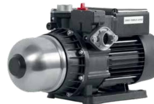
Автоматические станции водоснабжения применяются для подачи чистой воды из колодца, накопительной емкости или внешнего магистрального водопровода. Перекачиваемая жидкость не должна содержать абразивных, химически активных веществ и древесноволокнистых включений. Установка включает в себя насос, двигатель, гидроаккумулятор и электронный контроллер.
