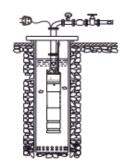
Перед покупкой и установкой насоса проверьте, соответствует ли внутренний диаметр скважины минимальному диаметру скважинного насоса. Необходимо убедиться в наличии достаточного зазора (не менее 5 мм с обеих сторон) между корпусом скважинного насоса и стенкой обсадной трубы, а также в отсутствии ее деформаций и повреждений, выступов, наплывов и т.д. При работе двигателя, который охлаждается водой, следите за уровнем жидкости согласно инструкциям производителя.
