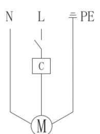
Подключение электродвигателя со встроенным пусковым конденсатором
