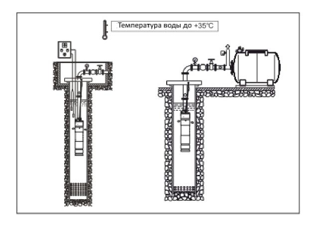
Погружной винтовой насос является важным оборудованием для подъёма воды с повышенным содержанием песка, глины и других мелких механических загрязнений из скважин диаметром от 100 (76 для SBO-0,5-80) мм и более из глубоких скважин, а также, при использовании охлаждающего кожуха, колодцев, накопительных емкостей, рек, прудов и т.д. При эксплуатации блок должен быть полностью погружён в воду.
